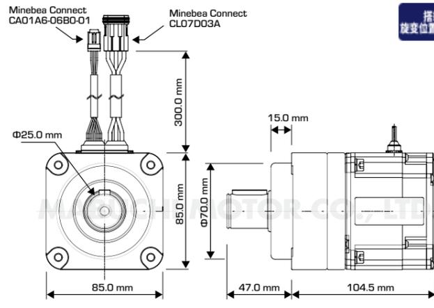
搭载 旋变位置传感器 防水等级 IPX4 减速比 10 电磁制动器
