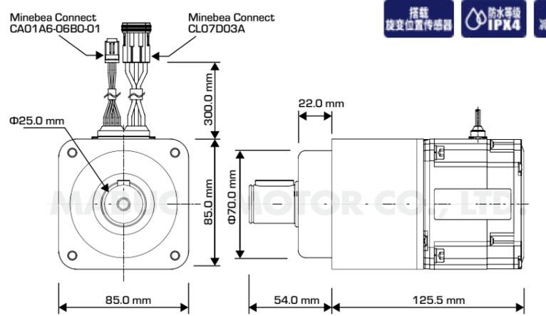
搭载 旋变位置传感器 防水等级 IPX4 减速比 20 电磁制动器
