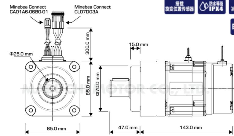
搭载 旋变位置传感器 防水等级 IPX4 减速比 10 电磁制动器
